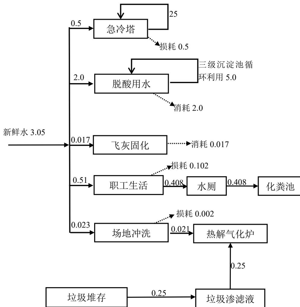
图 3-4 本项目水平衡图 (m³/d)
