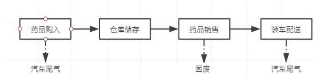
图 2-6 生产工艺流程及产污环节示意图
